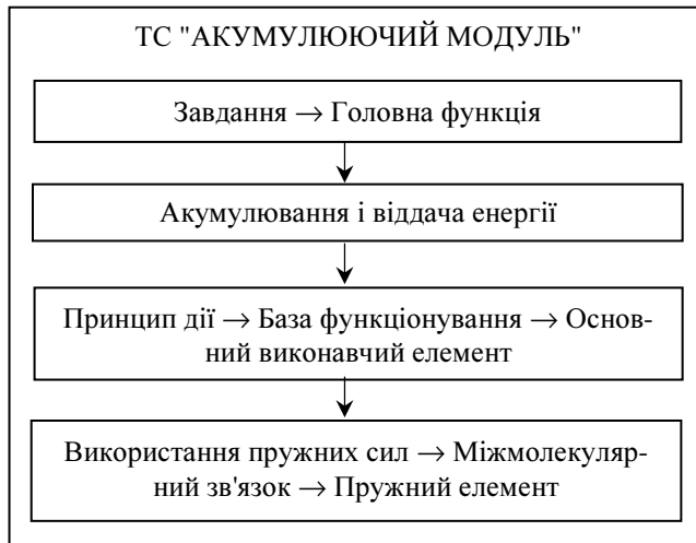
Рис. 6. Виділення головної функції та принципу забезпечення її виконання у ТС "Акумуляуючий модуль"
